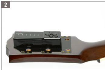
2 Colóquese la plaqueta de contacto al reverso del clavijero. Verifíquese que el logo de Tronical esté al derecho.
