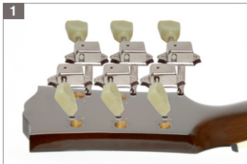
1 Remuévase todas las clavijas originales del clavijero.
