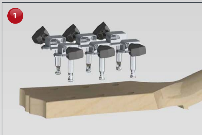
1 ギターから元の糸巻き関連のパーツを全て外します。
